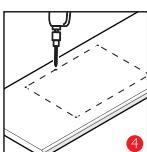
4. Сверлом сделайте сквозное отверстие внутри линии шаблона, возьмите электролобзик и произведите выпил вдоль карандашной линии.
