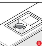
8. После нанесения силиконового герметика установите мойку по месту. Возьмите кастрюлю, наполните ее водой и поставьте в чашу мойки, так мойка плотнее прижмется к столешнице. По контуру мойки удалите излишки силиконового герметика и оставьте на 30 минут. После этого установите сифон и сливной клапан.
