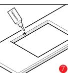
7. Уберите мойку с поверхности столешницы, возьмите силиконовый герметик и нанесите его по контуру выреза. Наносить стоит единой линией, без прерывания.
